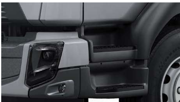
GRADINI ACCESSO CABINA con un rientro di 80 mm tra i due gradini per agevolare la salita.
