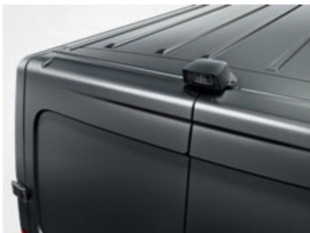
**3** RETROVISIONE CONTINUA con una telecamera posta sul retro del tetto per monitorare il traffico stradale posteriore.
